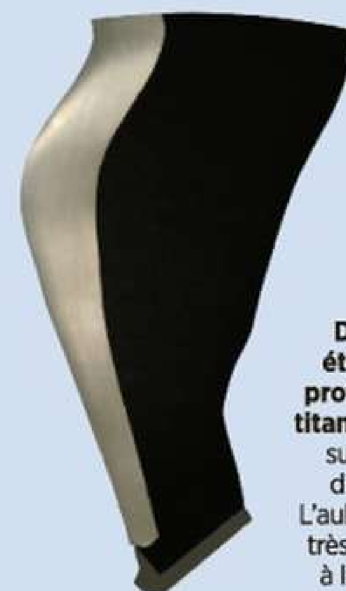
Une fois la résine solidifiée, l'aube est extrêmement rigide, légère et résistante à la délamination.
