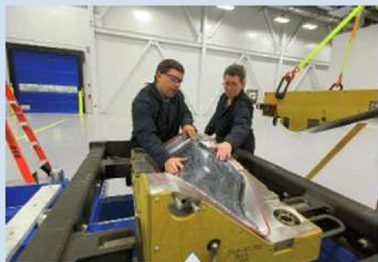
Après le tissage, une résine durcissante est coulée dans l'aube placée dans un moule.
