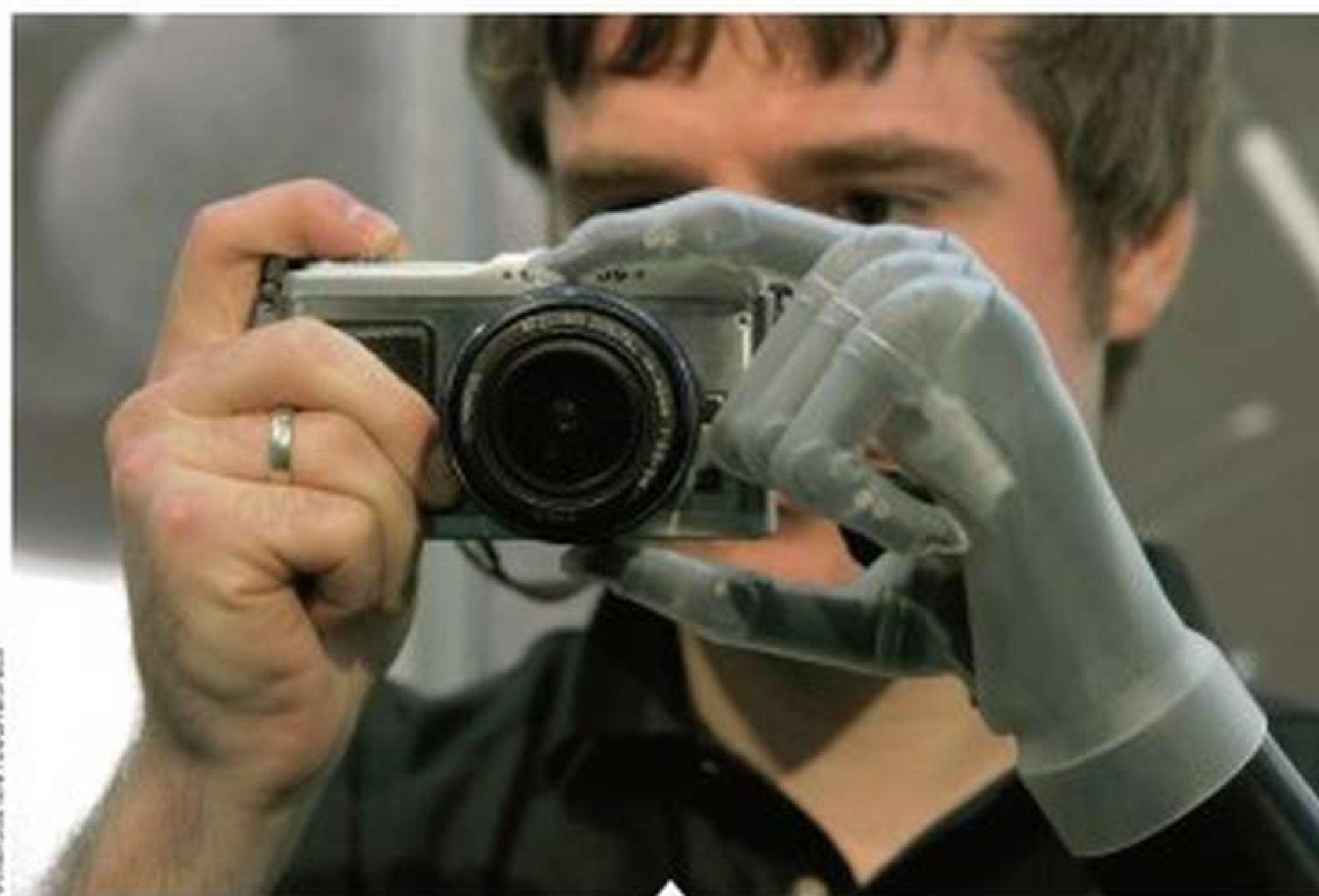
Les prothèses bioniques les plus récentes, avec rotation du pouce, permettent des gestes extrêmement fins.
