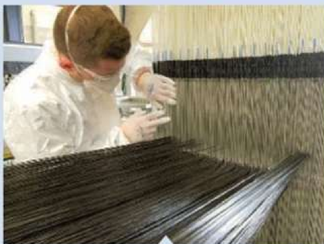
Ces fils de carbone sont placés dans les lisses qui effectuent le tissage.
