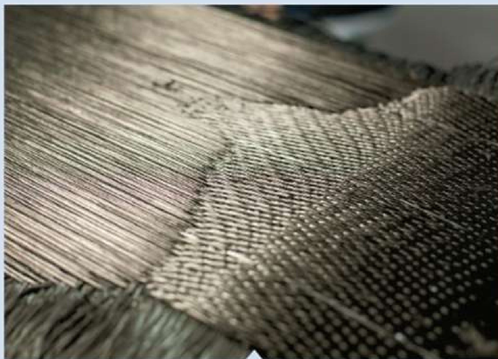
Une vue détaillée révèle des motifs de tissage complexes, adaptés aux contraintes que doivent supporter les différentes parties de l'aube.
